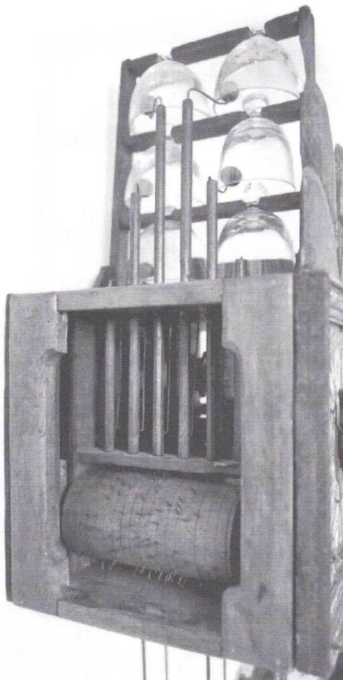
5. Mechanizm grający - szklane dzwoneczki, młoteczki uderzeniowe oraz drewniany wałek pozytywki; fot. Danuta Knapik-Rykaczewska
