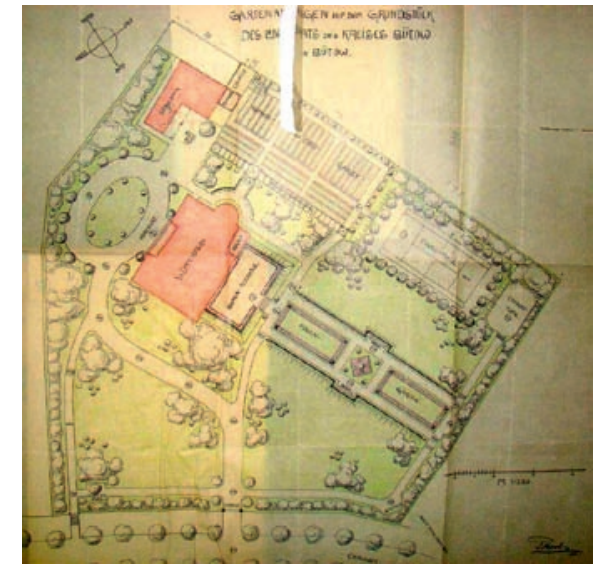
7b. Foto rysunku projektowego z 1910 r. – założenie ogrodowe na działce domu landrata powiatowego w Bytowie, skala 1:250, projektant architekt E. Paulus/Berlin; wariant, kolorowana kalka papierowa. Przy granicy wschodniej mieszkanie służbowe kuczera, ogród warzywny z kompostownikiem, kort tenisowy i do krokieta, od strony południowej willi taras kwiatowy, parter ogrodowy z pergolą i szpalerami róż. W budynku od 1975 r. znajduje się przedszkole, na potrzeby którego w 2022 r. na terenie najwyższym planowany jest parking (w proj. ogród warzywny, plac tenisowy i do krokieta).
